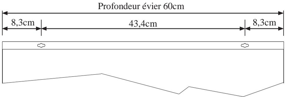
Installer le dessus inox en vous assurant que les 4 orifices inférieurs sont bien centrés sur les 4 vis.
