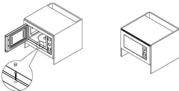
2. Ouvrez la porte four à micro-ondes. Positionnez la vis (composant 3) dans le trou et vissez. Placez le cache-vis (composant 2).
