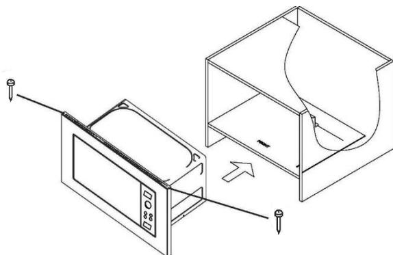
1. Installez le four à micro-ondes dans la niche d'encastrement, le maintenir à l'horizontal. Veillez à bien le centrer. Positionnez les vis (composant 1) dans les trous sur le dessus du four à micro-onde et vissez au meuble.
